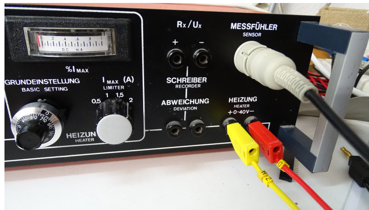
Figura 2.18 – Sensor y Heater de segunda etapa conectados al controlador HR1.
