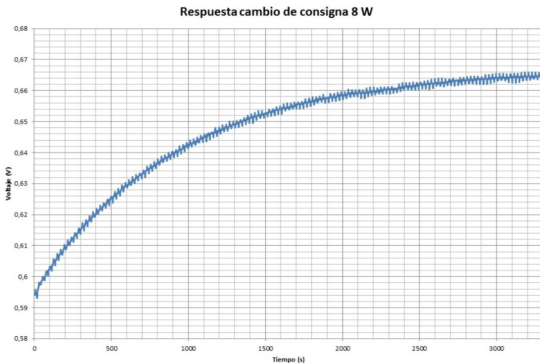
Figura 5.11 – Cambio de consigna del sistema aplicando 8 \text{ W} .
