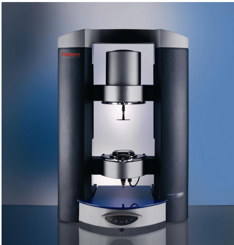
Figura 12: Reómetro Haake Mars III utilizado para las mediciones reológicas de este trabajo de Tesis Doctoral.
