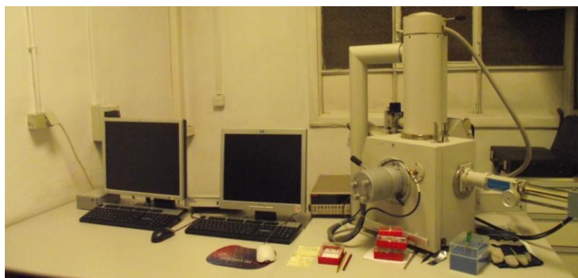
Figura 11: Microscopio electrónico de barrido FEI Quanta 200 utilizado para el análisis morfológico de los biomateriales generados en esta Tesis Doctoral.
