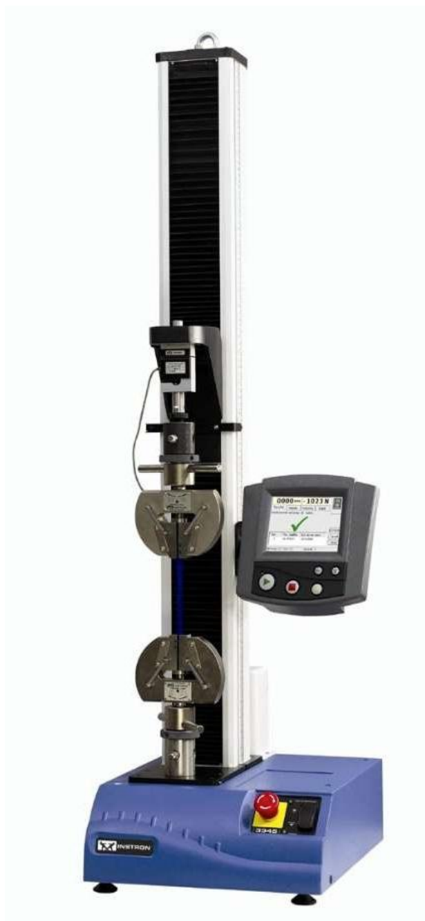
Figura 13: Instrumento de medición electromecánico Instron 3345-K3327 utilizado en este trabajo de Tesis Doctoral para las mediciones de tracción y compresión.
