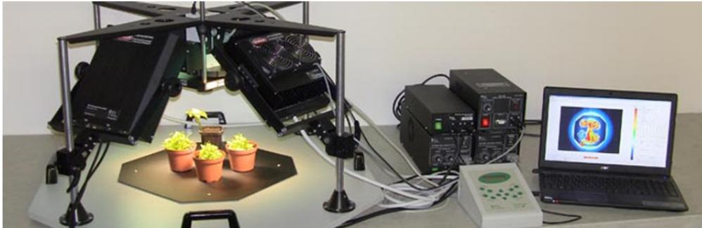
**Figura 18. Modelo Open FluorCam FC 800-O.** En él que puede apreciarse con detalle el sistema de iluminación, que es similar al de nuestro equipo (<http://www.psi.cz/products/fluorcams/open-fc-800-o-1010>).
