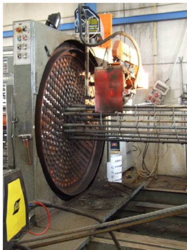
Fig. 4.16 Fabricación industrial del armado de un pilote
