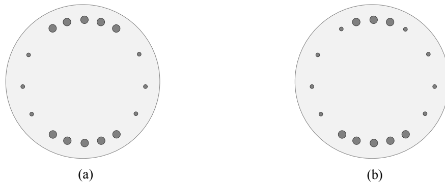
Fig. 4.14. Pilotes “bi-simétricos”: (a) los máximos valores de la envolvente de flectores tiene valores similares pero distinto signo; (b) solución a emplear cuando el máximo valor del flector en un sentido es mayor que el máximo en el otro
