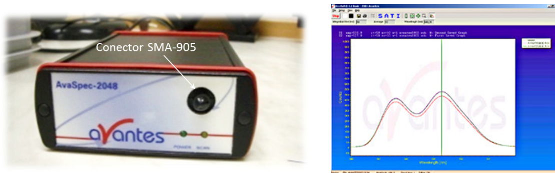
Figura 1.8: Fotografía del espectrómetro de fibra óptica comercial usado para la adquisición de las medidas de intensidad de luminiscencia en el sistema de medida propuesto. También se muestra una captura de pantalla del software usado para controlar dicho equipo.
