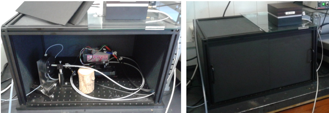
Figura 1.9: Fotografías del cuarto oscuro utilizado para alojar la celda de flujo y el módulo PMT en el sistema de medida propuesto.
