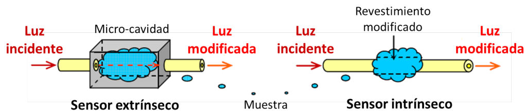
Figura AII.1: Diferencias entre un sensor extrínseco e intrínseco [52].
