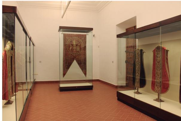
2. **Vitrinas Serie Córdoba:** Constan de un pedestal compuesto por una estructura metálica pintada y revestida de un tablero aglomerado, chapado, en madera barnizada. Tiene dos marcos de perfiles especiales de acero, pintados y revestidos de aluminio anodizado. Los vidrios de cerramiento tienen 8 mm de espesor. La iluminación es superior mediante tubos fluorescentes de baja emisión ultravioleta, y las cerraduras están ocultas.
