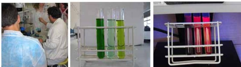
**Fig. 5.** Cromatografía en columna del extracto de espinacas (izqda) y fluorescencia en color rojo de la fracción correspondiente a la clorofila de color verde.
