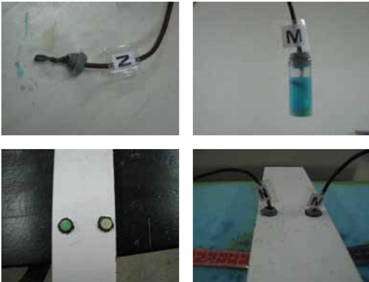
Fig. 4. Electrodos impolarizables M y N y soporte de madera.
