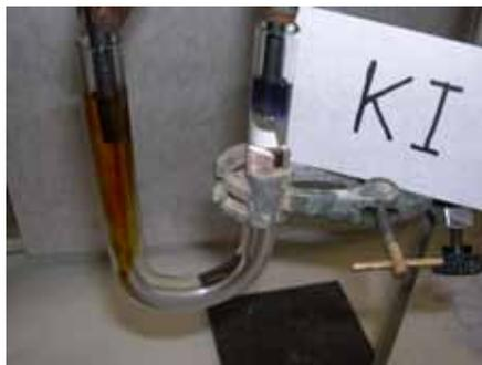
**Figura 5.** *Electrolisis de una disolución de ioduro potásico.*
