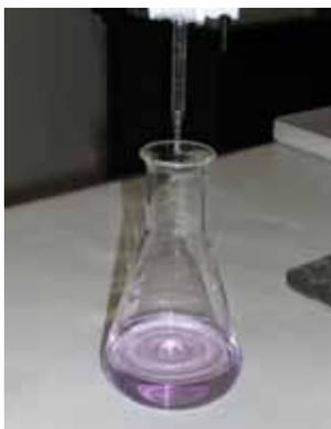
**Figura 3.** Valoración de NaOH con  $H_2SO_4$  utilizando Rojo de Cresol como indicador.
