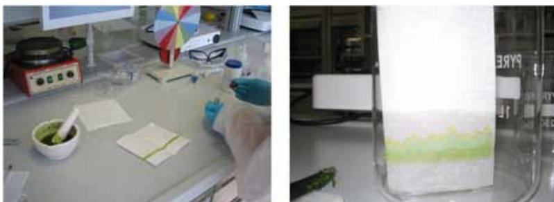
**Fig. 4.** Un estudiante deposita un poco del extracto de espinaca en papel (izqda) para su cromatografía eluyendo con hexano.
