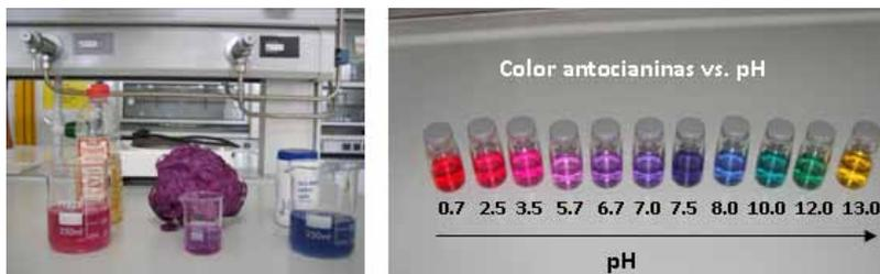
**Fig. 1.** Extracto acuoso de col lombarda y color al añadir vinagre y bicarbonato sódico (izqda); gama de colores que puede obtenerse del extracto acuoso variando su pH.
