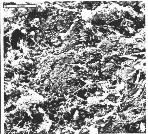
Figura 8.48.- Fotografías de microscopia electrónica de barrido de superficie que muestran los cambios sufridos por la biopelícula en la columna anóxica debido a los lavados del sistema.
