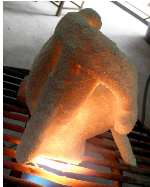
6º: Cocción del molde: se prepara en un soporte estable y se procede a la cocción.
