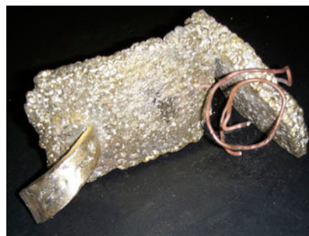
Pieza obtenida en bronce a partir del modelo original en poliestireno expandido y gomaeva.
