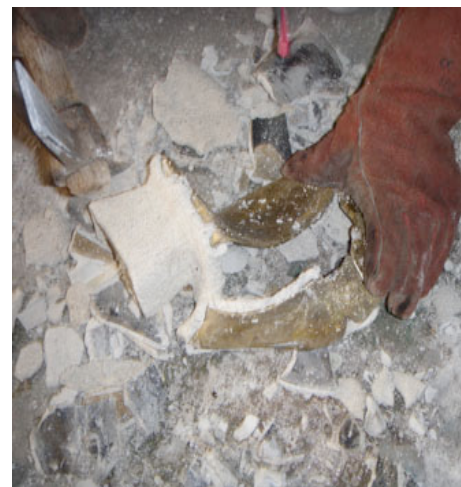
9º: Desmoldeo del conjunto. Extraemos la pieza en metal
