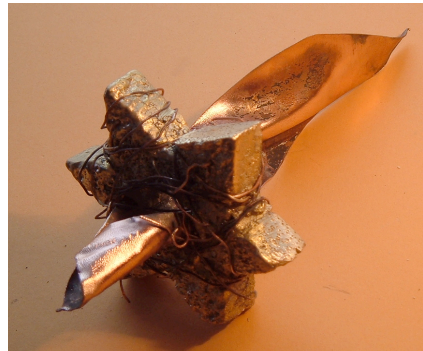
Pieza obtenida en bronce a partir del modelo original en poliestireno extruido y cobre.
