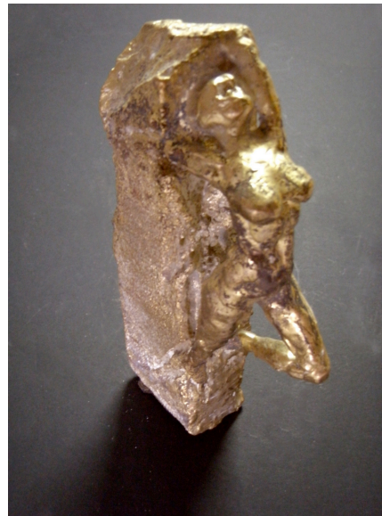
Pieza obtenida en bronce a partir del modelo original en Poliestireno extraído y cera . (Isabel Lozano)
