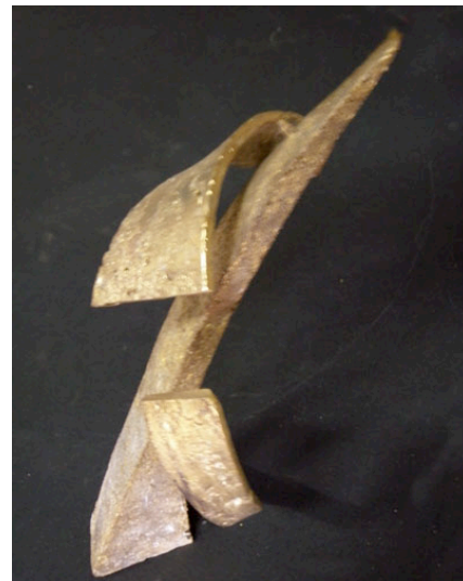
Pieza obtenida en bronce a partir del modelo original en poliestireno extruido y gomaeva.
