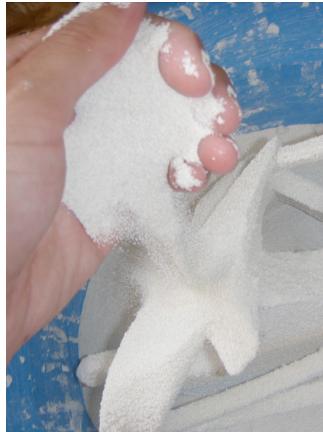
4º: 2ª fase de moldeo: seguidamente al baño, se espolvorea una arena refractaria en distintas granulometrías.
