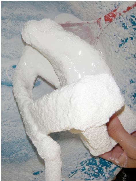
5º: Consistencia del moldeo: estas dos anteriores operación se repiten 3-4 veces hasta obtener un molde resistente.
