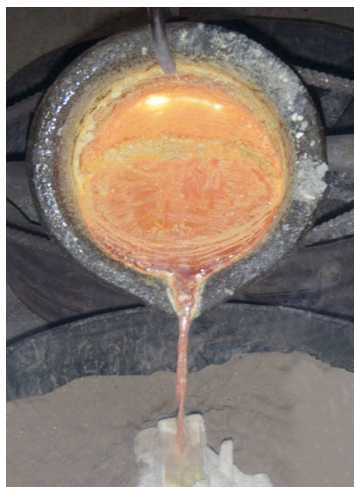
8º: Vertido del metal fundido
