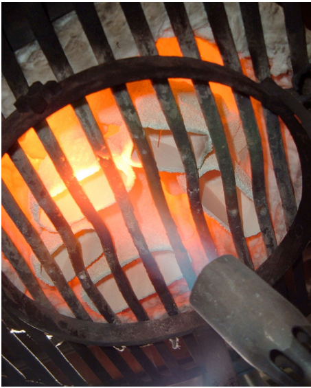
7º: Cocción: en este momento el molde realizado en capas, adquiere un carácter cerámico que le da la consistencia necesaria para soportar el vertido del metal fundido en su interior.
