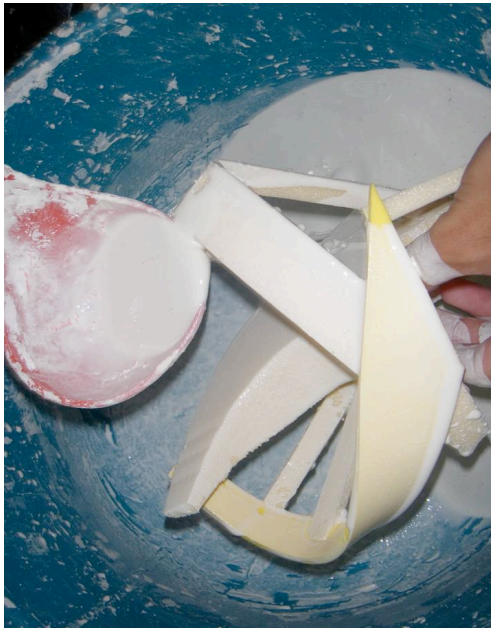
3º: 1ª fase de moldeo: el diseño se cubre con un baño cerámico.
