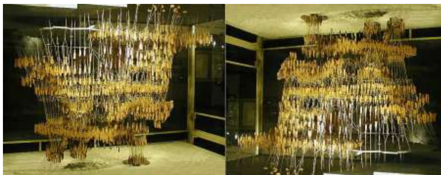
Fig. 1. Maqueta funicular de la Cripta de la Colonia Güell.
