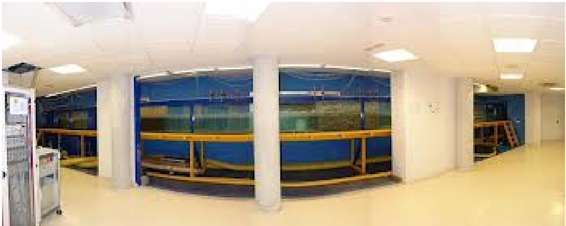
Figura 3.2: Foto 2: Canal de oleaje de corriente, CEAMA-UGR
