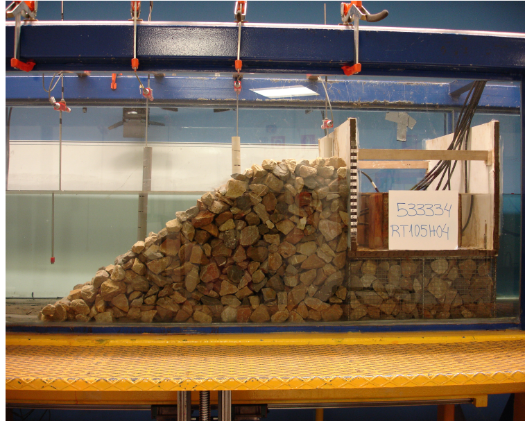
Figura 5.4: Dique, Diámetro 52mm
