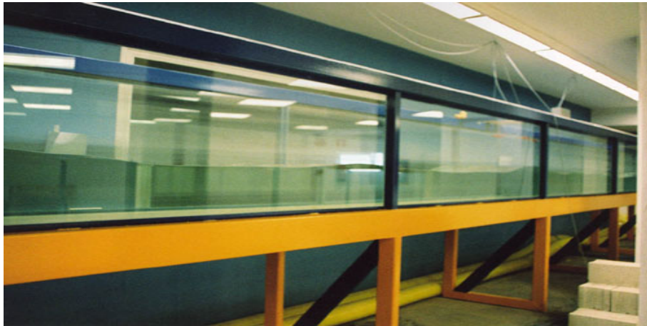
Figura 3.1: Foto 1: Canal de oleaje de corriente, CEAMA-UGR
