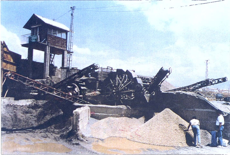
Figura 3.5. Vista del equipo principal con tolva alimentada por pala, cinta transportadora, criba, equipo de lavado y cintas de salida.
