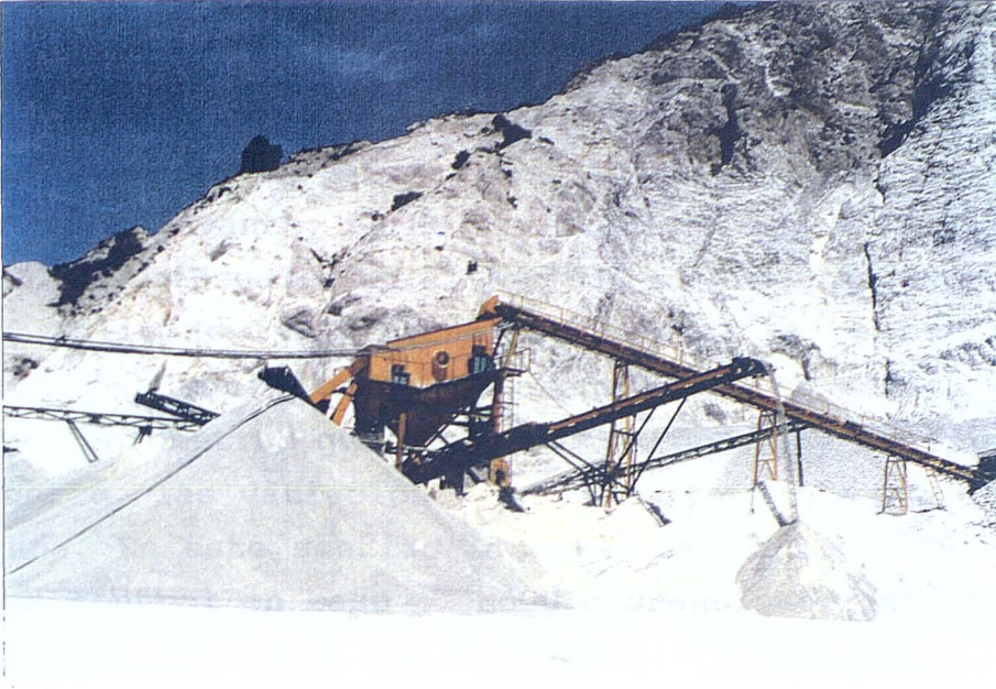
Figura 5.5. Toma de muestra en punto de descarga de la cinta transportadora.
