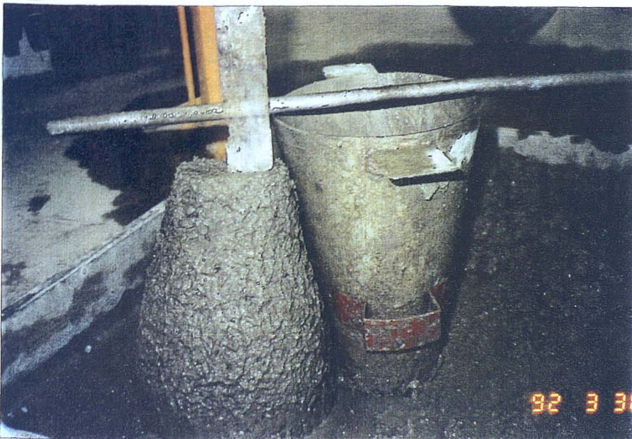
Figura 5.32. Medida del asiento en cono de Abrams.
