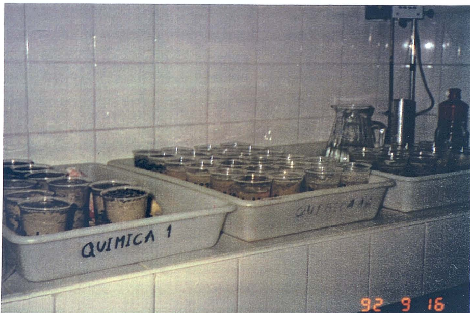
Figura 5.14. Preparación de muestras para el ensayo de azul de metileno. Proceso de saturación previa.
