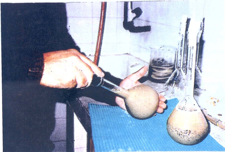
Figura 5.26. Eliminación de las burbujas de aire atrapadas en el agua introducida en el picnómetro.
