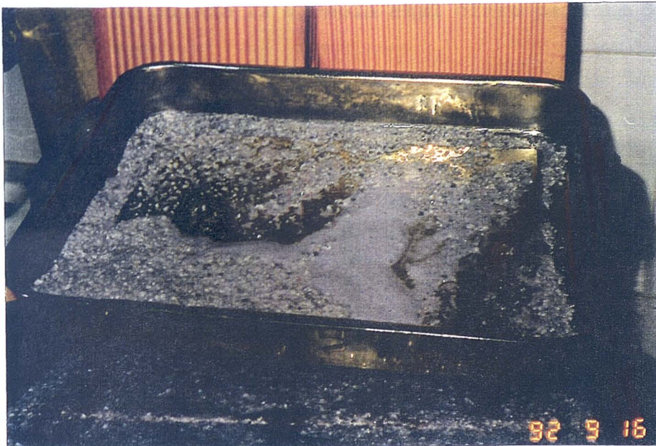
Figura 5.18. Lavado de finos después de realizar el ensayo de azul de metileno.
