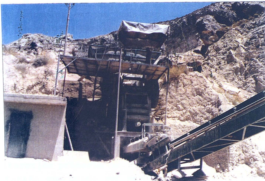
Figura 3.3. Vista del equipo de molienda (machacadora de mandíbulas) y cinta transportadora del equipo de cribado.
