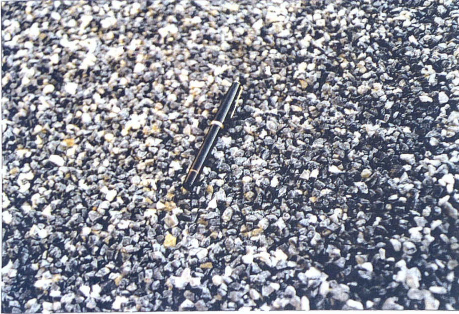
Figura 5.9. Existencia de partículas blandas en una grava dolomítica del sector Padul-Dúrcal.
