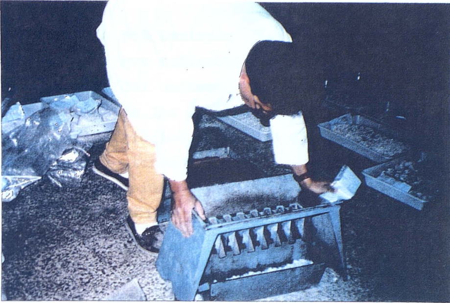
Figura 5.7. Preparación, mediante cuarteo en laboratorio, de muestras para ensayo.
