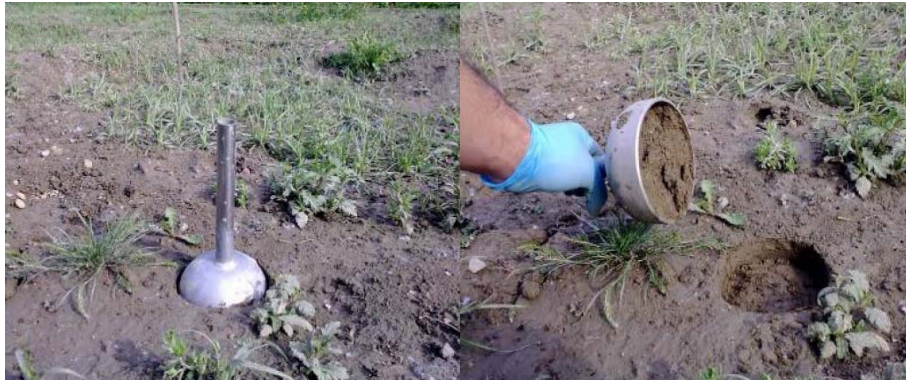
Figura VI.9. Toma de muestra superficial, muestreador de 2 cm de calado
