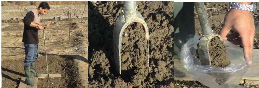
Figura VI.10. Toma de muestras de 10, 20, 30, 40, 50 y 60 cm, barrena helicoidal
