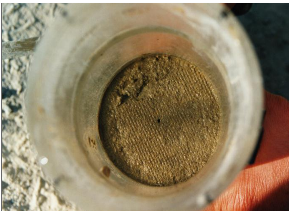
Foto 17.- Orificio de aguas arriba después del ensayo
