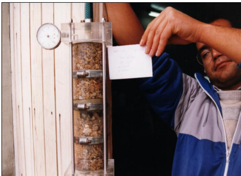
Foto 19.- Ensayo NEF con gran erosión
