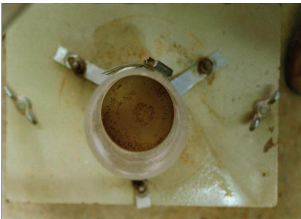
Foto 10.- Superficie de la segunda tongada de suelo base compactado
