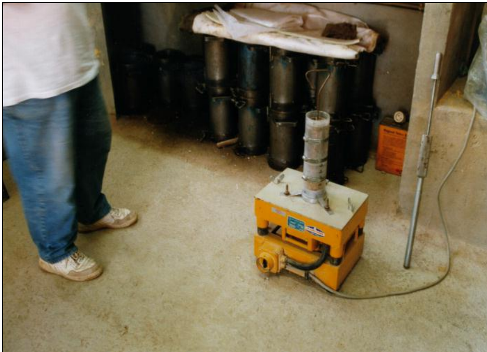
Foto 6.- Compactación del filtro por vibración con sobrecarga
