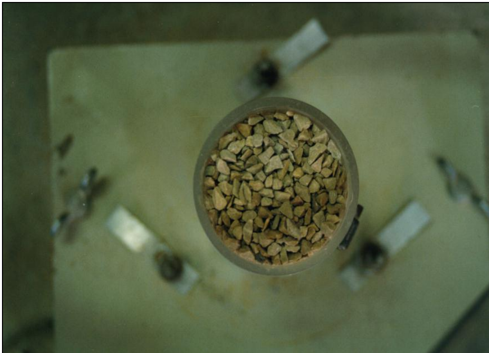
Foto 14.- Colocación de la grava de tranquilización
