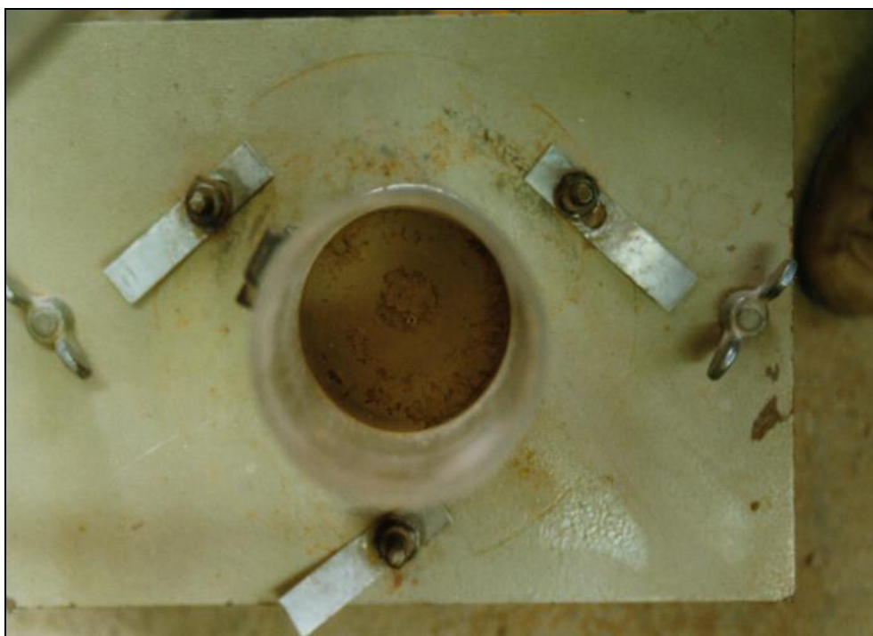
Foto 12.- Orificio de 1 mm después de perforar
