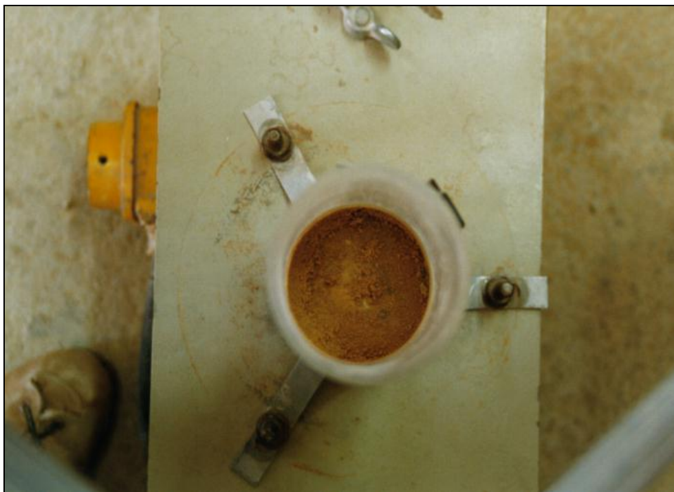
Foto 7.- Supeficie del filtro después de compactar
