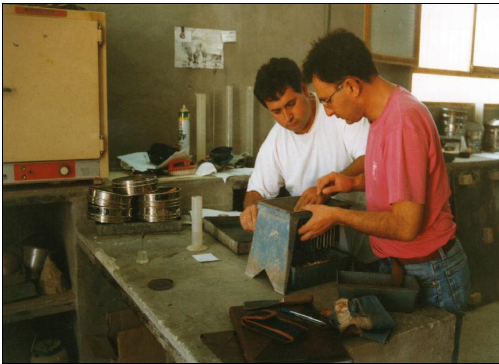
Foto 4.- Operación de cuarteo del filtro
