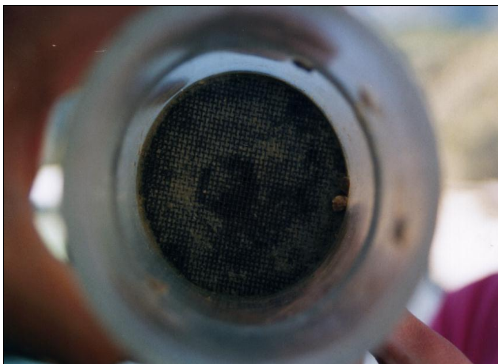
Foto 22.- Ensayo NEF con gran erosión: vista desde aguas arriba
