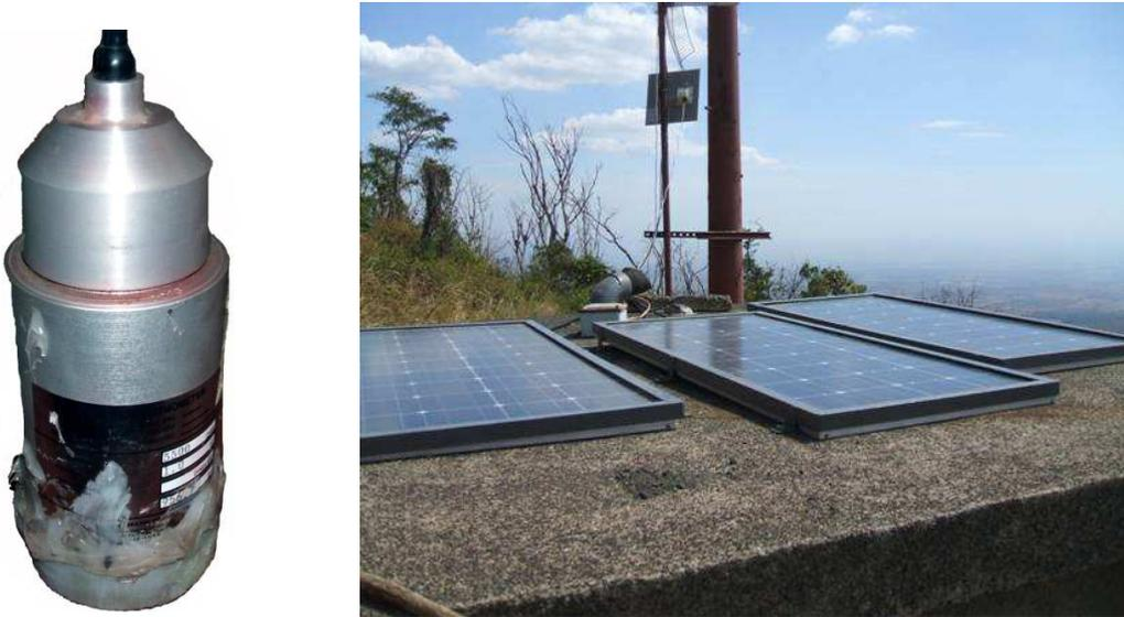
Fig. 3.24 A la izquierda Sismógrafos verticales MARK serie Cs5016, provistos de sensores L4C-1 Hz, a la derecha paneles solares que alimentan las baterías, GPS para sincronizar el tiempo de registro y antena retransmisora en las casetas sísmicas. Fuente Ligdamis Gtz.
