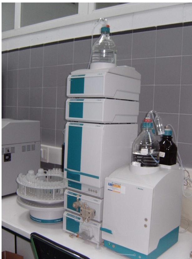
Figura 30. Imagen de cromatógrafo iónico Metrohm®.
