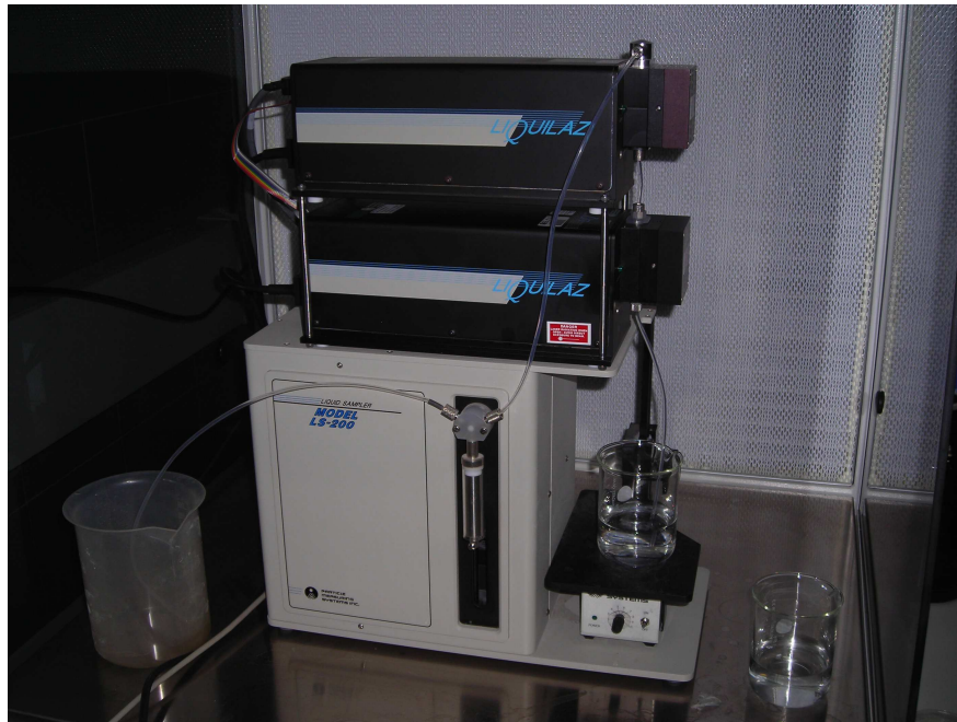
Figura 27. Medidor de partículas LiQuilaz-E20 particle counter
