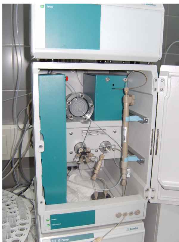
Figura 32. Imagen de cromatógrafo iónico Metrohm® detalle columna CO2150.
