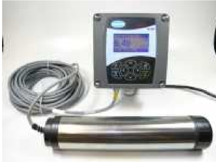
Figura 26. Sonda de oxígeno disuelto el LANGE LDO™ / sc100
