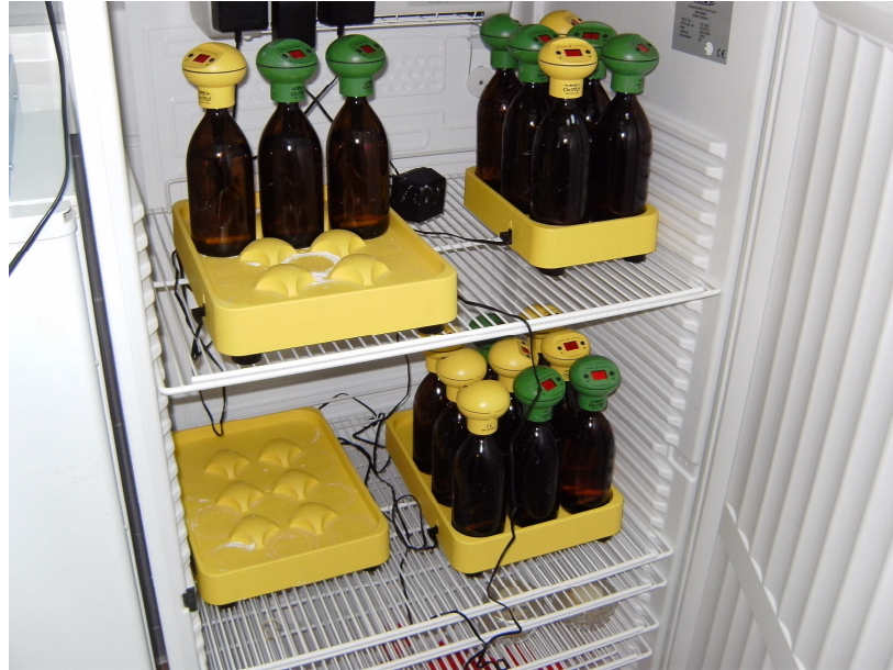
Figura 21. Frascos Oxitop y frigotermostato.
