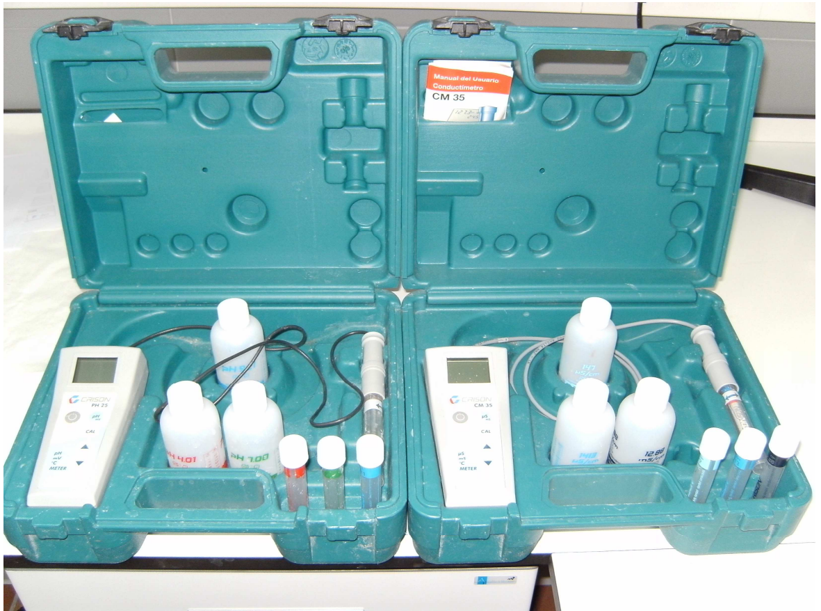
Figura 25. pHmetro (izquierda) y Conductímetro (derecha) Crisol.
