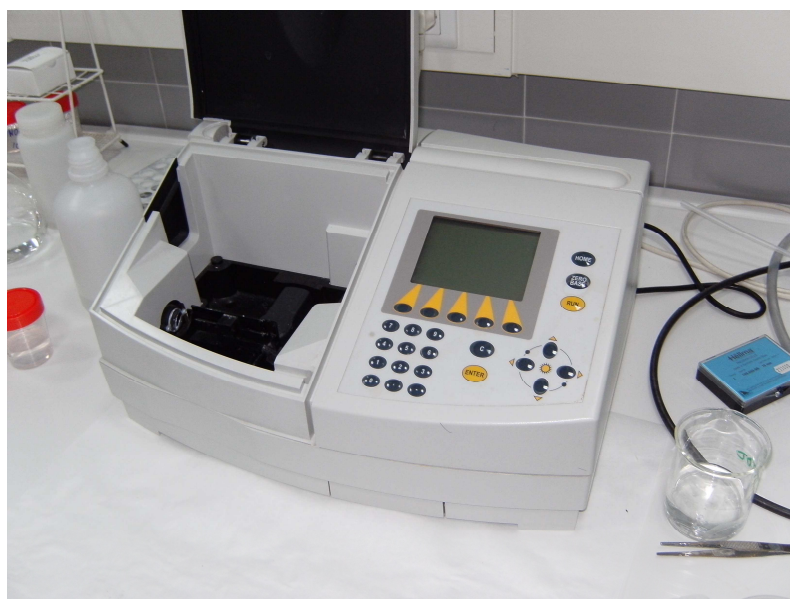
Figura 22. Espectrofotómetro Helios \gamma spectrophotometer.
