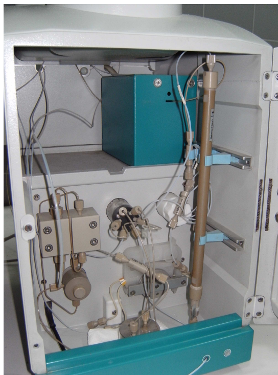
Figura 31. Imagen de cromatógrafo iónico Metrohm® detalle columna ASUPP5.
