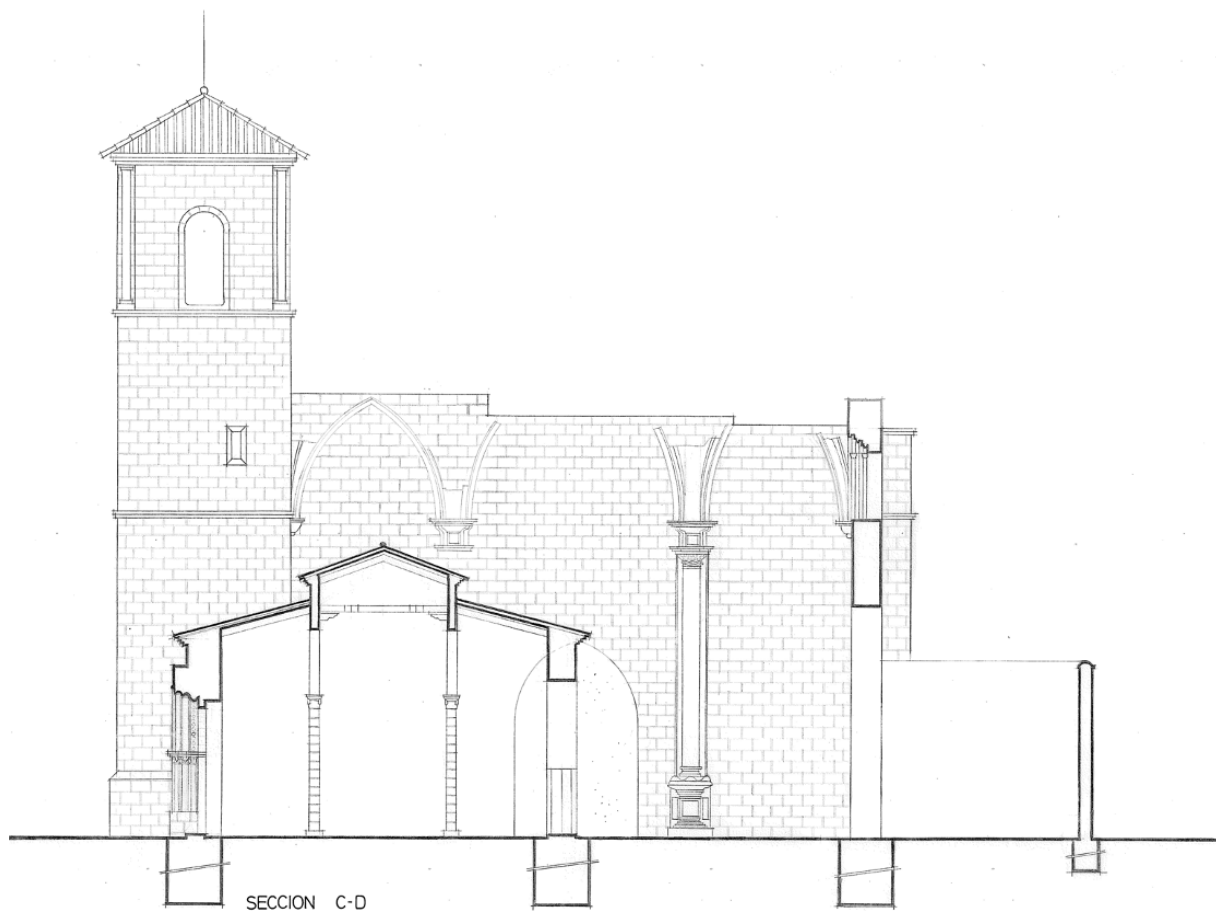
Fig. 182. Sección. Se observa la diferente escala de lo que iba a ser la ampliación del templo. Proyecto de restauración de las ruinas de la basílica del Salvador, Baeza (2ª fase). AELL, expediente nº280, planos 5LL-6LL/izq caja-10.
