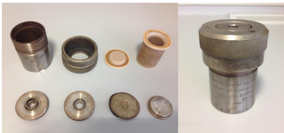
Figura 1.3. Autoclaves utilizadas en síntesis hidrotermal.
