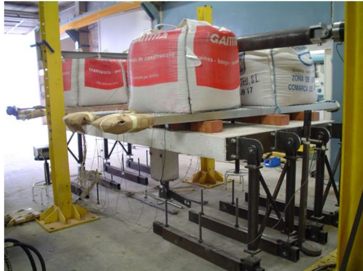
Fig. 3.1: Espécimen de conexión pilar-placa interior de forjado reticular en laboratorio
