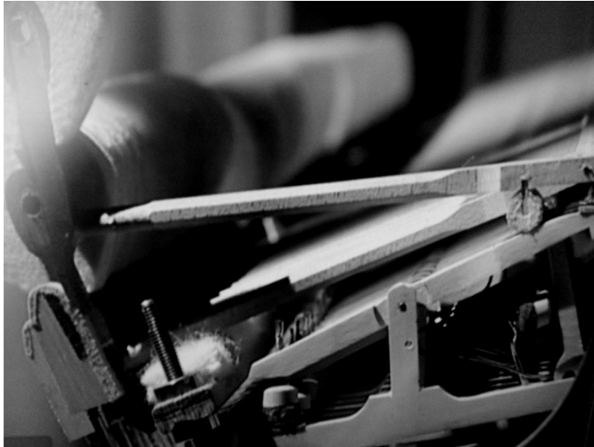
Figura 4: Mecanismo de un piano moderno, detalle macillos en acción. Foto Marcela Linari. Musée de la Musique, París.
