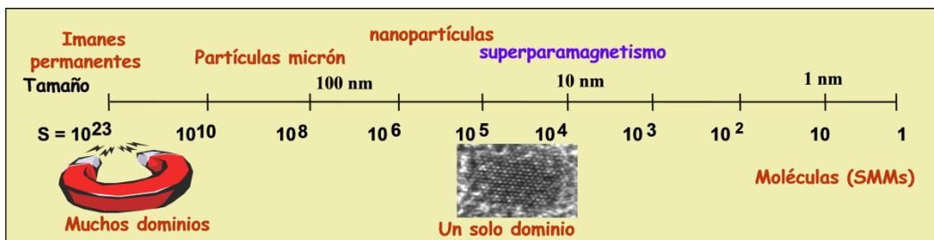
**Figura 4.9.-** Tipos de materiales magnéticos en función del tamaño.
