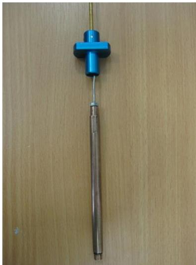
**Figura A.7.-** Celda utilizada para presiones < 160 bar.
