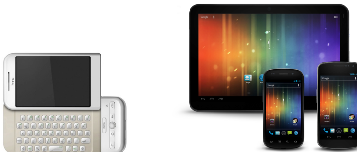
Figura 4-8 HTC Dream, primer terminal con Google Android (izquierda) y dispositivos modernos de la plataforma Android (derecha).
