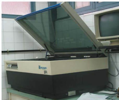
Figura II.13. Espectrómetro de Centello PACKARD TRi-Carb-1500. Fuente: [5].
