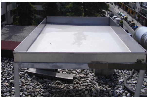
Figura II.3. Batea de recolección de muestra de agua de lluvia, tanto deposición seca como húmeda.
