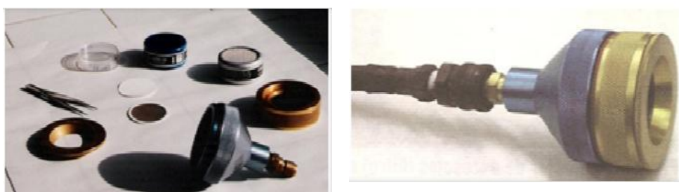
Figura II.1. Filtros y componentes del sistema de captación de aerosoles.
