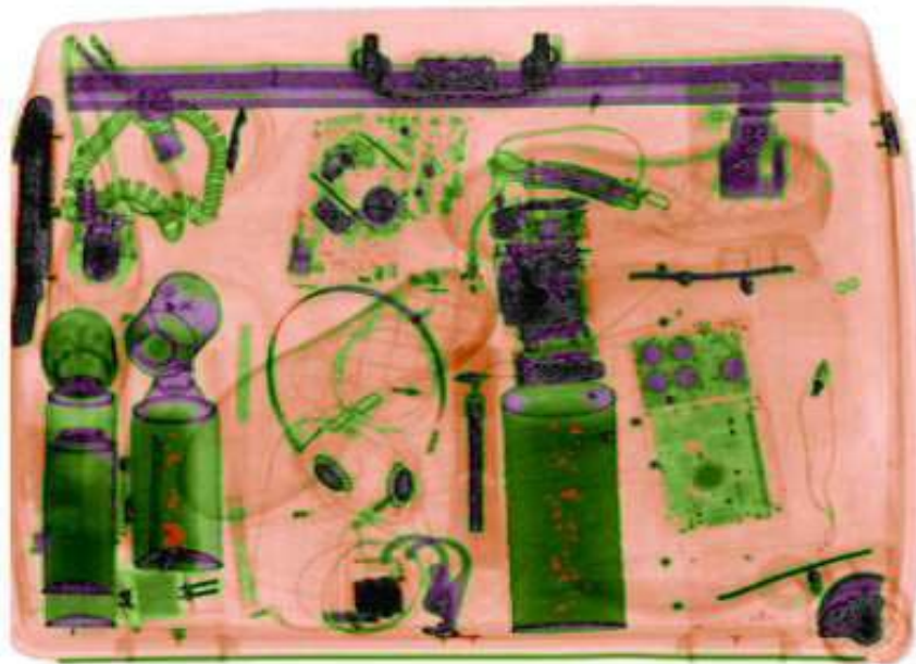
Fig. 27. Resultado del visionado de una maleta a través del escáner por rayos X.
