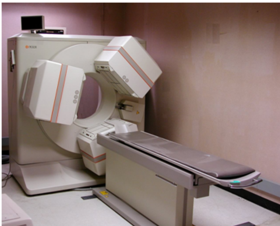
Figura 8.1: Cámara gamma para la obtención de SPECT del Hospital Universitario Virgen de las Nieves, Granada.
