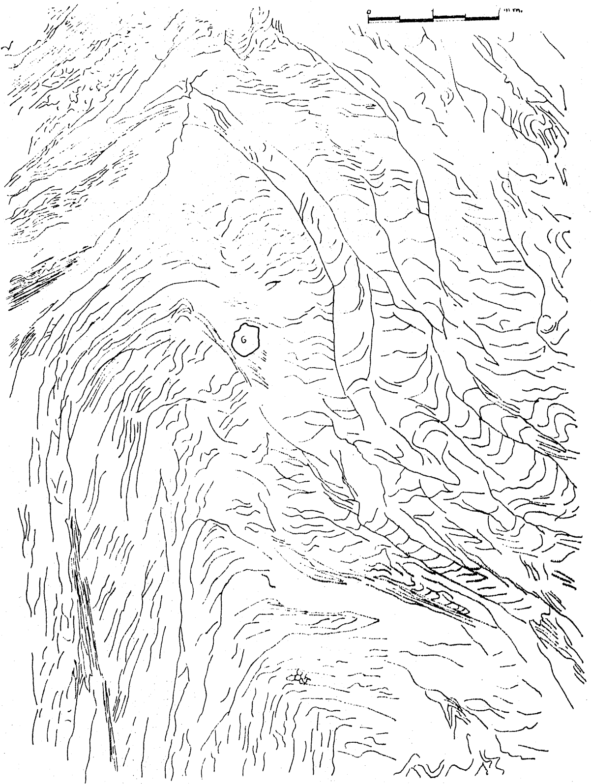
Fig.2-55 h. Núcleo de chevron fracturado . Una esquistosidad que envuelve al único blasto de granate visible es crenulada por una S mas espaciada y ,el conjunto, plegado por flexión. Parece existir una esquistosidad mas antigua y penetrativa que es atravesada limpiamente por el granate y está mejor representada en la escasas concentraciones micáceas de esta metapeli- ta en que predomina un fino agregado de cuarzo cristaloblástico .
