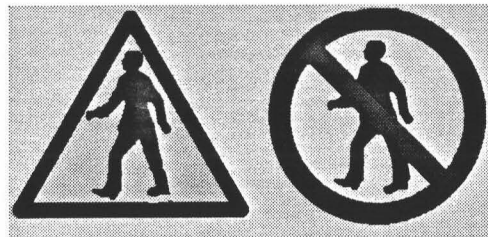
Fig. 45. A: Peligro para el hombre, B: Prohibida la presencia humana.
