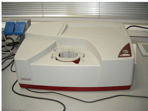
Figura 2. Espectrofotómetro de infrarrojo TERMO NICOLET IR200
