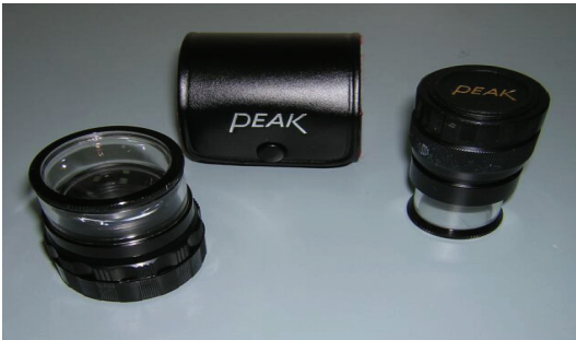
Fig. 1. Lupas de Peak para la medida de la zona óptica de las lentes rígidas.
