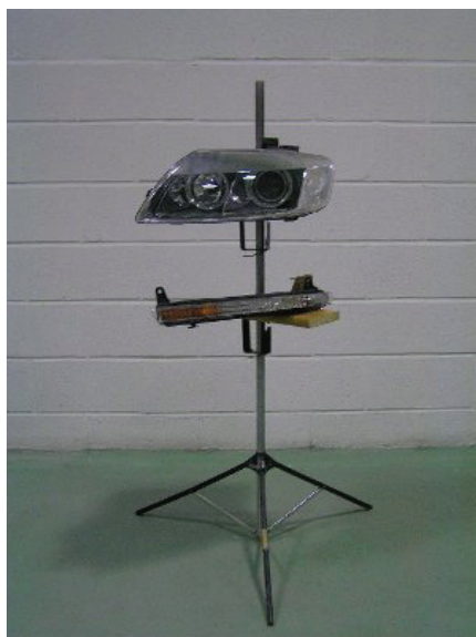
Fig. 1: Disposición de los faros durante la práctica de DRL, en la asignatura de Luminotecnia.
