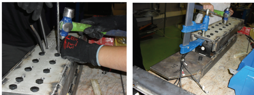
Figura 8.2: Proceso de ensamblaje de las piezas para formar el disipador WPD
