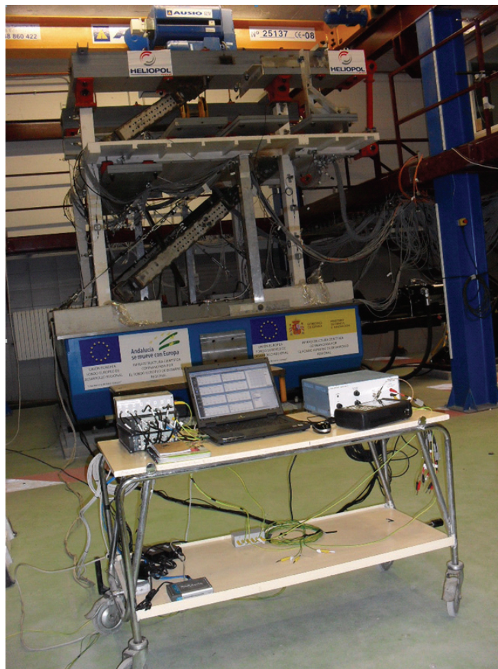
Figura 8.14: Imagen de la estructura provista con disipadores sobre la mesa sísmica al fondo y el equipo usado para los ensayos de vibraciones en primer plano
