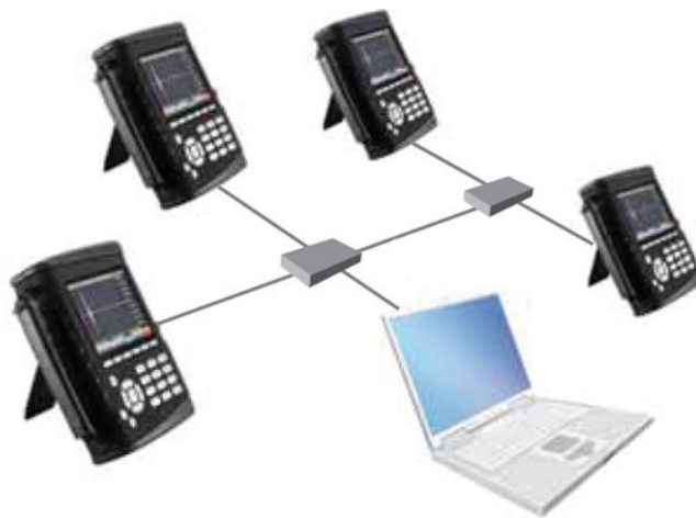
Figura 4.46: Red LAN entre módulos CoCo-80 [23]
