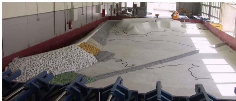
Figura III.5.8. Modelo experimental dique Torres. Laboratorio de la Universidad de Granada (tomado de Informe final MO2v2, 2006).
