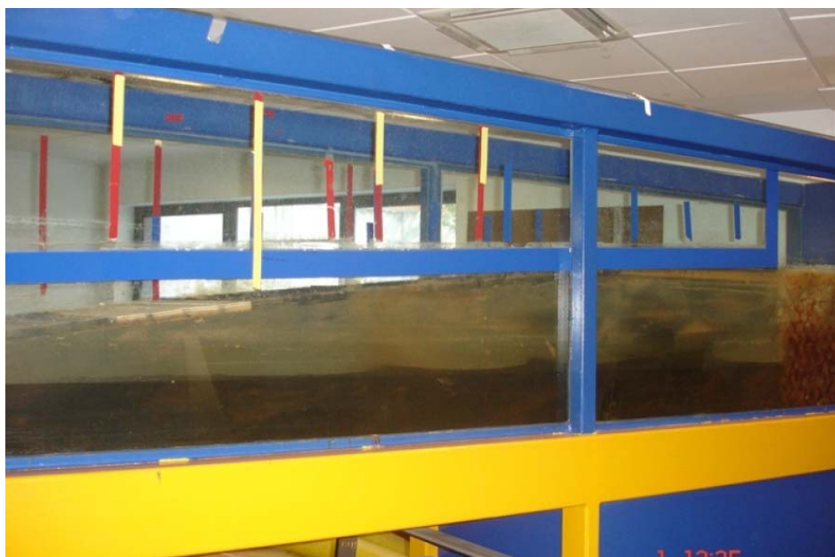
Figura II.5.4. Rampa dissipadora de energía canal ola-corriente CEAMA-UGR.
