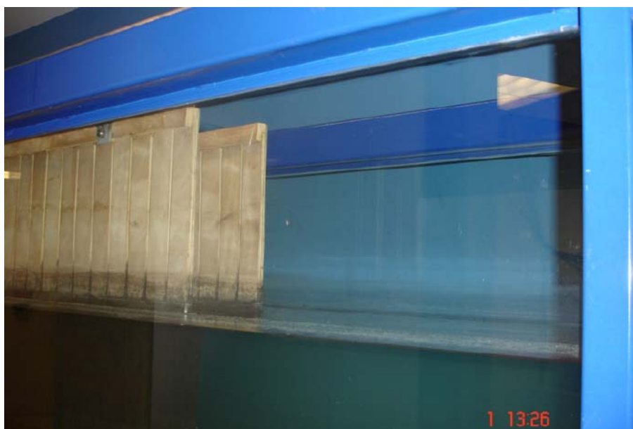
Figura II.5.5. Disipadores de onda transversal en el canal ola-corriente CEAMA-UGR.
