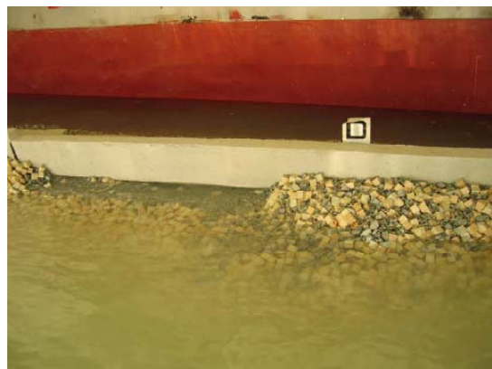
Figura 4.6. Destrucción del dique sección D para H = 10 m - T = 15 s, N (segunda tanda).
