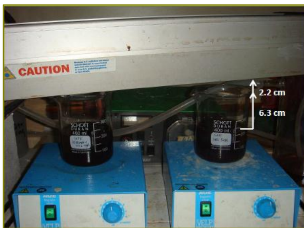
Fig. 5.I.3. Montaje para los experimentos escala laboratorio de fotocatalisis \text{TiO}_2/\text{UV} .
