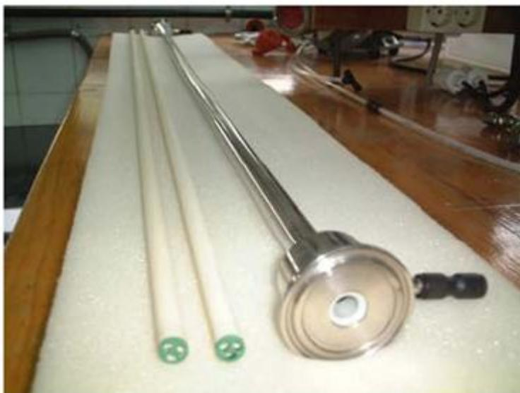
**Figura 4.1. Módulo y membranas de 1.2 m.**
