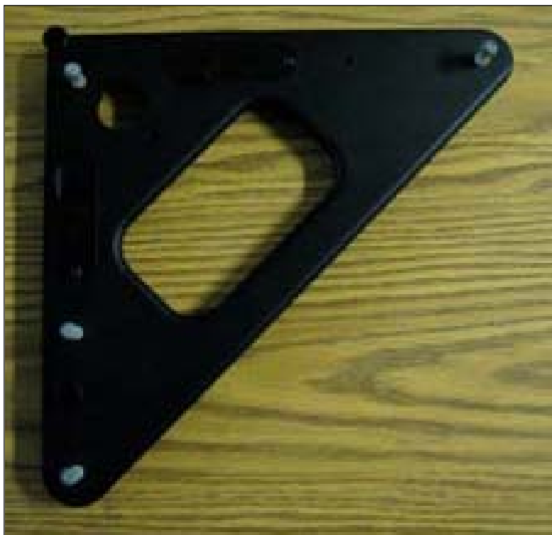
Figura 37.- Triángulo (de metal) (L-25mm), señalizador del origen (centro) del volumen a capturar: dotado de marcadores reflectantes.
