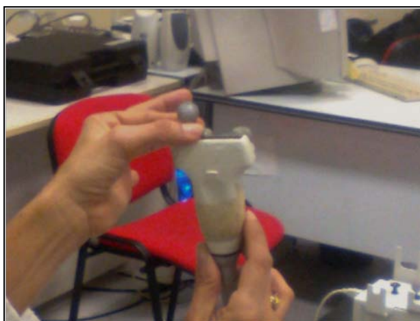
Figura 46.- Proceso de sincronización entre el ultrasonido y el sistema fotogramétrico.
