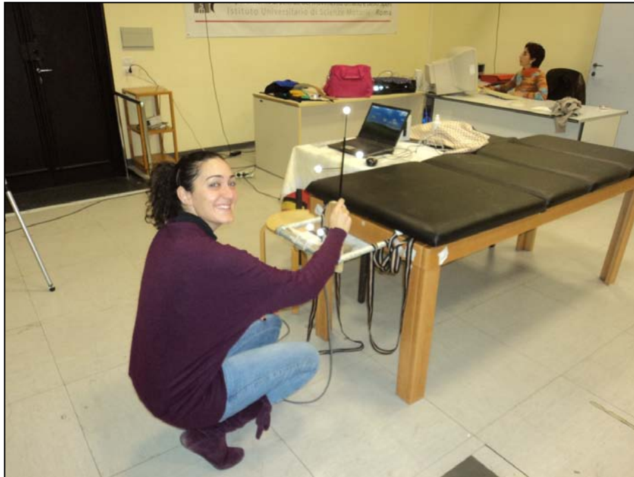
Figura 43.- Momento de la calibración del dinamómetro con la vara de calibración de tres marcadores: una persona ejecuta el desplazamiento de la vara de calibración sobre la parte superior e inferior del dinamómetro y otra persona hace la captura desde el ordenador con Vicon® - hardware(MX1.3 + ultranet HD) y software (nexus), equipado con 8 cámaras, Oxford, UK, de la posición del dinamómetro y del desplazamiento de la vara. (Este procedimiento se realizó con cada que se captura un sujeto).
