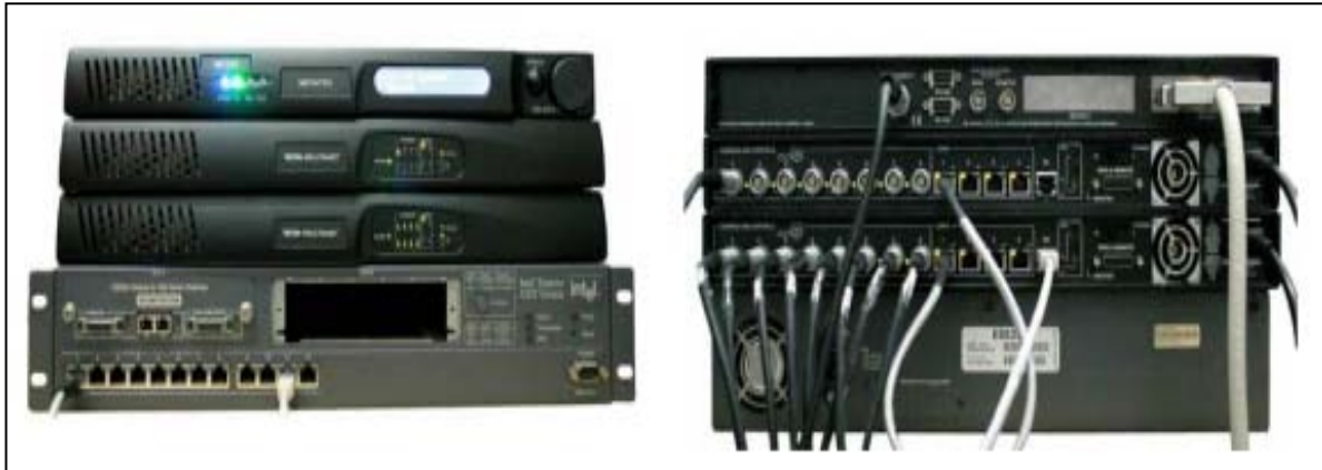
Figura 31. -Hardware (MX1.3 + ultranet MX) con sus componentes: Ultranet MX 1 y2 y el control MX, del Vicon
