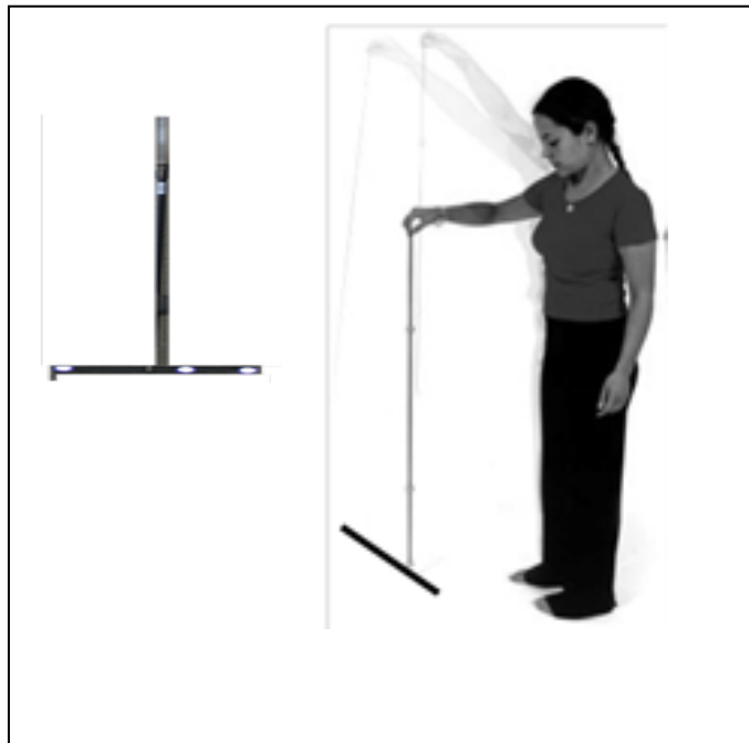
Figura 36.- Vara de calibración con 3 marcadores (390mm) y simulación de los movimientos que se realizaron para recorrer todo el volumen de captura con la vara de calibración.
