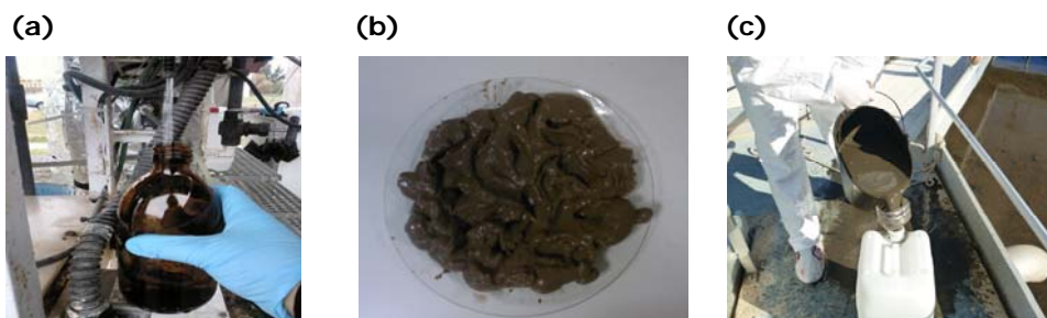
Figura 5.1. Recipientes de vidrio (a y b) y de teflón (c) fueron usados para el muestreo y almacenamiento de las muestras de agua y fango.
