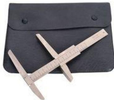
**Imagen 4.2. Paquímetro Holtain**
