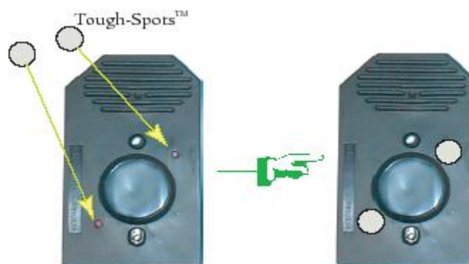
Figura 20. Colocación de los Tough Spots en el array.
