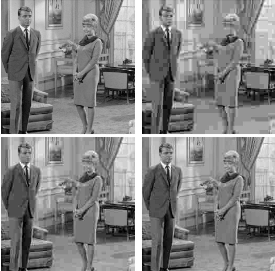
Figura 4.7: De izquierda a derecha y de arriba a abajo: Imagen *couple* original. Imagen comprimida a 0.20bpp. Imagen comprimida a 0.30bpp. Imagen comprimida a 0.50bpp.
