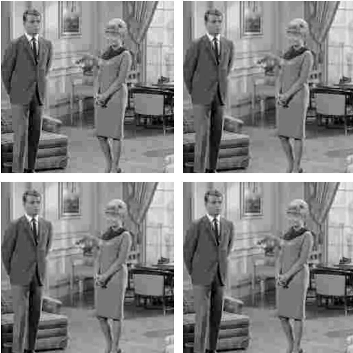
Figura 5.8: De izquierda a derecha y de arriba a abajo: Imagen *couple* comprimida a 0.30bpp,  $PSNR = 28.065$ . Reconstrucción con el Algoritmo 4.2 con los parámetros estimados en el decodificador,  $PSNR = 28.270$ . Reconstrucción con el Algoritmo 4.2 con los parámetros estimados en el codificador,  $PSNR = 28.225$ . Mejor reconstrucción en términos de  $PSNR$  con el Algoritmo 5.2,  $\mu = 0.0$ ,  $\nu = 0.2$ ,  $PSNR = 28.275$ .
