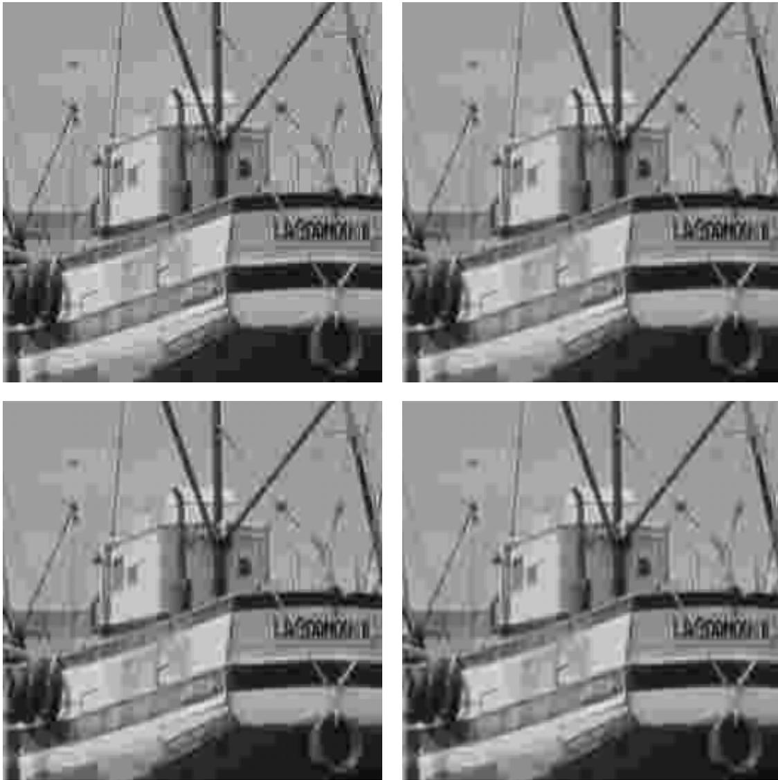
Figura 5.7: De izquierda a derecha y de arriba a abajo: Imagen *boats* comprimida a 0.20bpp,  $PSNR = 28.308$ . Reconstrucción con el Algoritmo 4.2 con los parámetros estimados en el decodificador,  $PSNR = 28.698$ . Reconstrucción con el Algoritmo 4.2 con los parámetros estimados en el codificador,  $PSNR = 28.713$ . Mejor reconstrucción en términos de  $PSNR$  con el Algoritmo 5.2,  $\mu = 0.4$ ,  $\nu = 0.0$ ,  $PSNR = 28.759$ .
