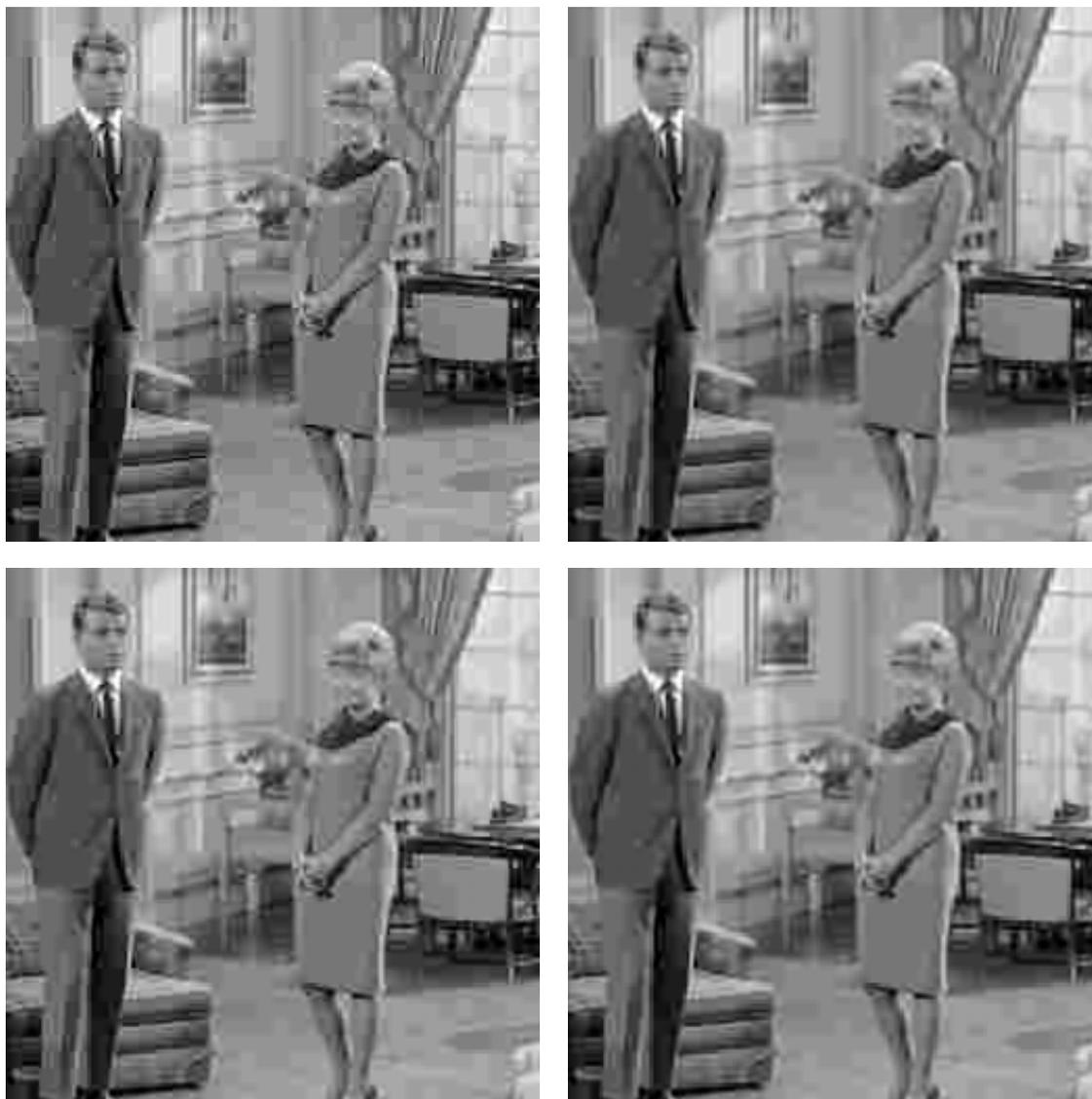
Figura 5.10: De izquierda a derecha y de arriba a abajo: Imagen *couple* comprimida a 0.30bpp,  $PSNR = 28.065$ . Reconstrucción con el Algoritmo 4.2 con los parámetros estimados en el codificador,  $PSNR = 28.225$ . Mejor reconstrucción en términos de  $PSNR$  con el Algoritmo 5.2,  $\mu = 0.0$ ,  $\nu = 0.2$ ,  $PSNR = 28.275$ . Reconstrucción en términos de  $PSNR$  con el Algoritmo 5.2,  $\mu = 1.0$ ,  $\nu = 0.0$ ,  $PSNR = 28.177$ .
