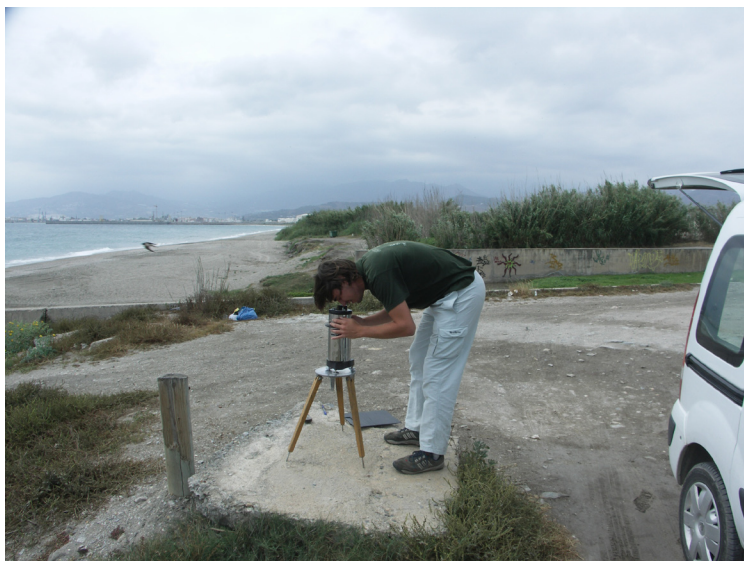
Figura 3.2. Realización de medidas gravimétricas en el campo con un gravímetro Worden modelo Master.
