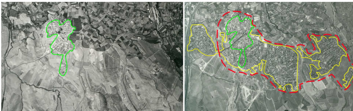
Figura 6.22: Dos fotografías aéreas del núcleo urbano y alrededores de Otura. A la izquierda tejido urbano existente en 1977. A la derecha en 2001. Con una línea verde se engloba el perímetro urbano de los años 70 y en amarillo la zona urbana desarrollada a partir de finales de los 80. La línea roja discontinua en la imagen de la derecha representa la zona afectada por subsidencia del terreno estimadas con la técnica DInSAR. Se aprecia claramente una gran coincidencia entre la zona de crecimiento urbano y la zona afectada de movimiento. (Fernandez et al. 2009)
