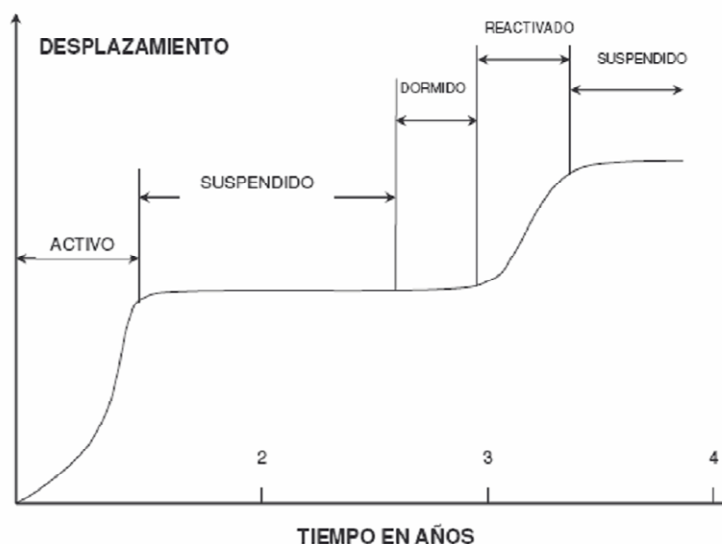
Figura 2.3: Desplazamiento de un deslizamiento en diferentes estados de actividad. En Cruden y Varnes 1996, modificado por Jiménez, 2005.
