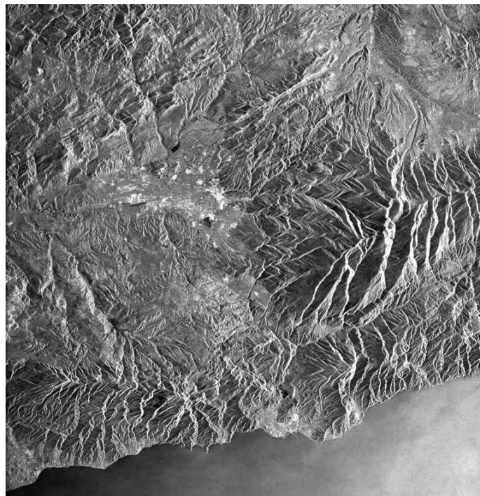
Figura 2.9: Ejemplo de imagen SAR de amplitud ERS1 del sur de la Provincia de Granada Comprimida 10 veces en azimut y 2 veces en range (Elaboración propia)
