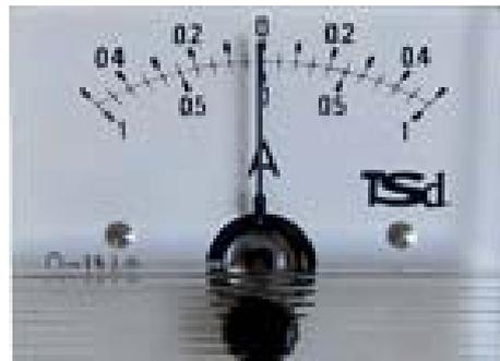
Figura 2. Escala de amperímetro
