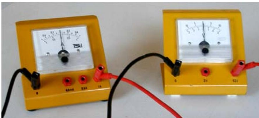
Figura 5. Amperímetro y voltímetro
