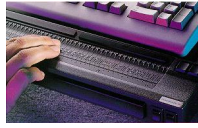
Figura 29. Pantalla tipo Braille para desplegar caracteres en alfabeto Braille de forma táctil.
