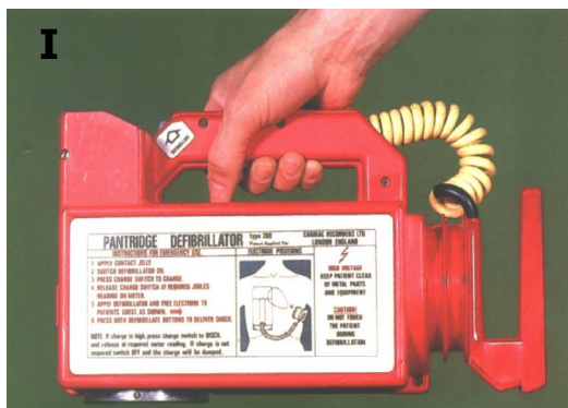
Figura 39: (I) Primer desfibrilador portátil peso aproximado 3,2 Kg. (D) Monitor-Desfibrilador actual.
