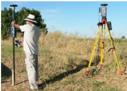
Foto 01. Teixidó et al. (2007). Pareja de receptores GPS. Cuando se usan coordenadas UTM, la base se calibra respecto a un vértice geodésico y, una vez realizadas las oportunas operaciones, con la unidad móvil se hace el estaquillado y la toma de datos topográficos del terreno. - El sistema también puede calibrarse a nivel local -.
