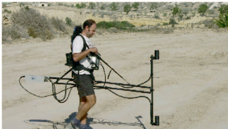
Figura 3. Magnetómetro de vapor de potasio con los dos sensores verticales separados 1 m. La zona se exploró mediante perfiles paralelos de ida-vuelta en dirección Norte-Sur y separados 1m entre sí. En este caso se tomaron 10 lecturas por segundo.
