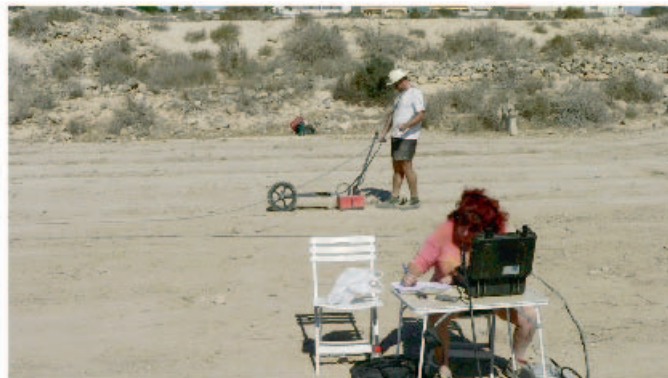
Figura 5. La obtención de datos rádar se realizó con una antena de 400 MHz (GSSI) que tiene acoplada una rueda marcadora para fijar con precisión la distancia de cada muestra. En la parte inferior de la imagen puede verse la consola de recepción y gestión de los datos.
