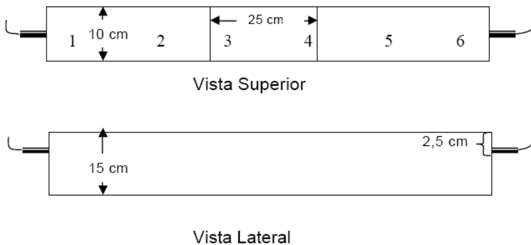
Figura 4.5. Esquema de las vigas y posición de los puntos de medición de potencial
