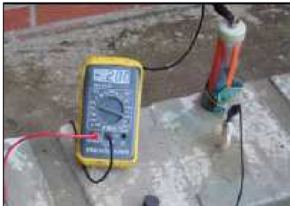
Figura 4.3. Medición de potencial del acero en las probetas con electrodo de \text{Cu}/\text{CuSO}_4
