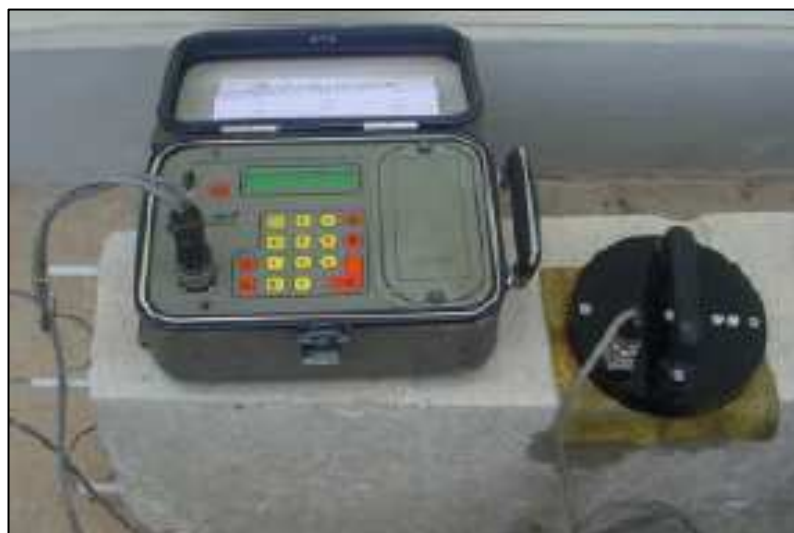
Figura 4.6. Equipo GECORR6, utilizado para la determinación de la velocidad de corrosión en las barras de acero de las vigas
