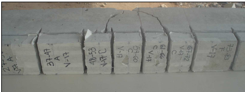
Figura 4.18. Viga con cortes para la determinación de cloruros libres
