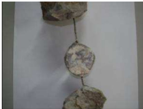
Figura 5.135. Ánodo de aluminio/cinc/indio después de su remoción
