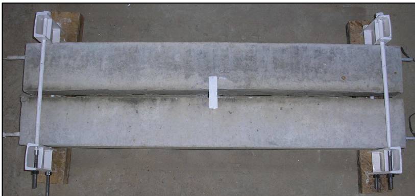
Figura 4.8. Sistema de carga aplicado a las vigas de hormigón
