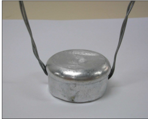
Figura 4.27. Ánodo de aluminio/cinc/indio usado en la segunda reparación
