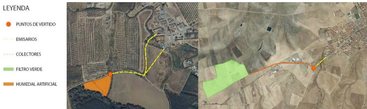
Figura 4. Ejemplo de Propuesta de Depuración no Convencional
