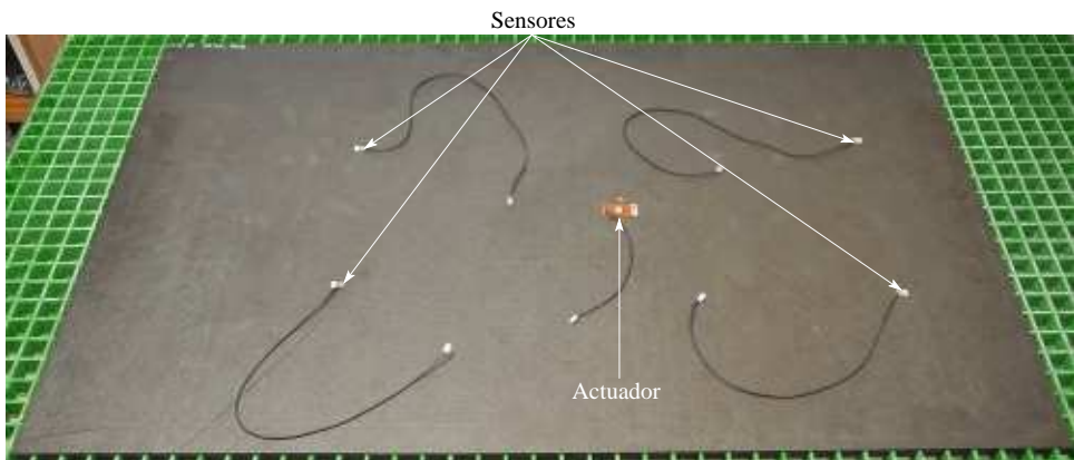
Figura 3.4: Placa CFRP2 instrumentada con un actuador y cuatro sensores PZT.
