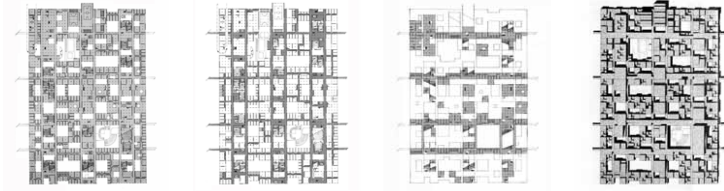
F116 _ Candilis-Josic-Woods, proyecto ejecución Toulouse le Mirail, Facultad de letras, sistema arquitectónico "mat-building", 1.966-70. Plantas baja, Planta baja ejes circulaciones, Planta primera, Planta módulos cubierta. CAPA
