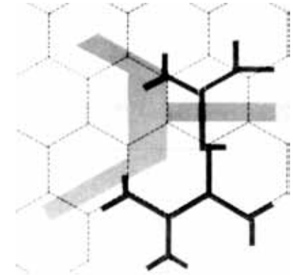
F19_ Candilis-Josic-Woods, proyecto Toulouse le Mirail, estudio base hexagonal grandes bloques residenciales. Esquema planta. AMT
