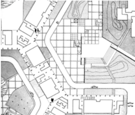
F37 _ Candilis-Josic-Woods, proyecto ejecución 1ª fase Toulouse le Mirail, Bellefontaine, detalle permeabilidad pórticos grandes bloques, 1.962-64. Planta
