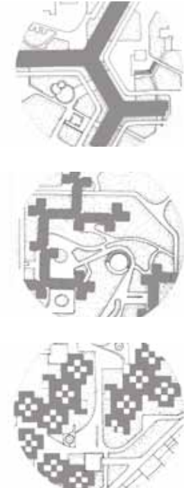
F50 _ Candilis-Josic-Woods, proyecto ejecución 1ª fase Toulouse le Mirail, tres tipos densidades de viviendas 1.962-64. Esquema planta: Grandes bloques, pequeños bloques, villas-patio. CAPA
