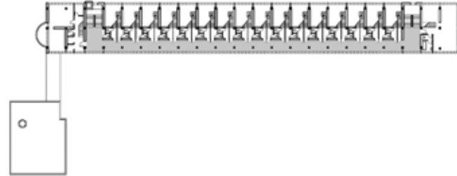
F11_ Moisei Ginzburg e Ignaty Milinis, Narkomfin, Moscú, 1.928-29. Planta nivel 4, corredor acceso dúplex
