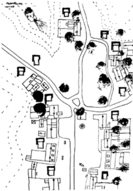
F10-F11 _ Alison y Peter Smithson, "cluster" escala de asociación - "fold houses", 1.955. Diagrama viviendas tipo y sistema de agrupación
