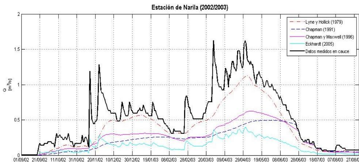
Figura 13; Algoritmos de separación de caudal base propuestos por diferentes autores aplicados en los caudales registrados en la subcuenca de Cádiar, Sierra Nevada.
