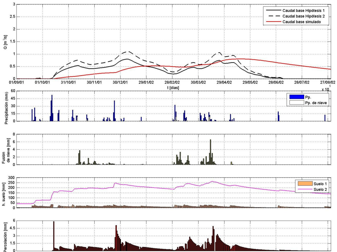
Figura 59; Simulación de calibración n° 1 correspondiente al periodo 2001-2002 en la subcuenca de Cádjar.
