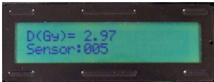
Figura 6.10. Dosis absorbida por el sensor 005, medida con P-03 mediante el algoritmo de tres intensidades pulsadas, sobre una dosis real de 2.99Gy.
